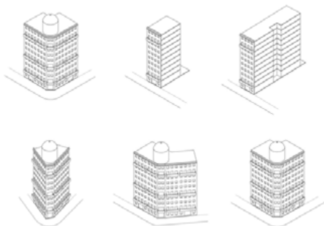
Figura 6: Máximas masas edificables frente a Av. Roque Saenz Peña según normativa 1928. Axonometrias.
