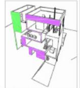
El diseño de estructura cruzada, no sólo distribuye la fuerza horizontalmente y verticalmente, sino también empujes diagonales que impiden el fracaso de la estructura de fuerza enorre que se une en un único punto débil. El soporte principal es una columna principal ubicada al lado derecho. Combinando este diseño de tres distribuciones cualquier fuerza de cualquier lugar de la casa se transmite exitosamente al suelo, ya sea por empuje vertical, horizontal y diagonalmente.
