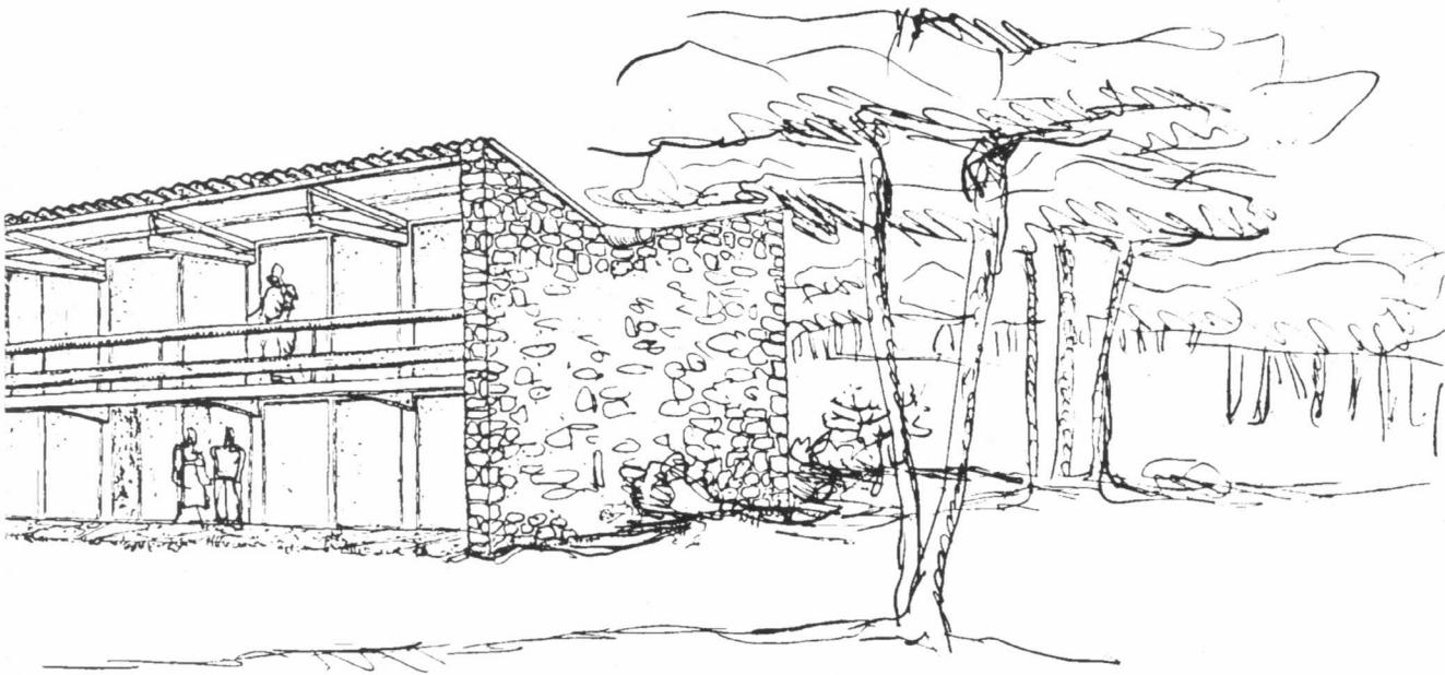
*descalzos. Otro es la naturalidad, casi desparpajo, con que se ha mezclado con la piedra el ladrillo que cierra el conducto de humo (incluido en el espesor del muro) del pequeño hogar que calefacciona la habitación grande de planta alta.*
