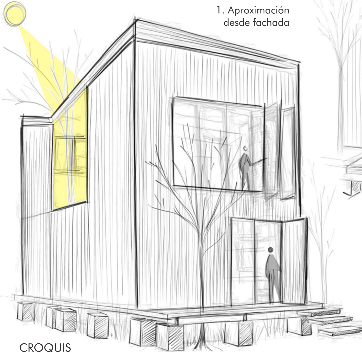
2. El acceso a la vivienda se genera mediante un deck que se encuentra elevado del terreno natural.
