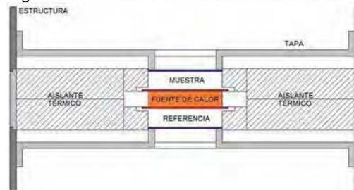
Diseño conceptual del medidor de transmitancia térmica de materiales secos
