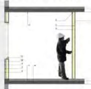
DETALLE CONSTRUCTIVO. Técnica de prefabricación en seco Esc. 1:20
